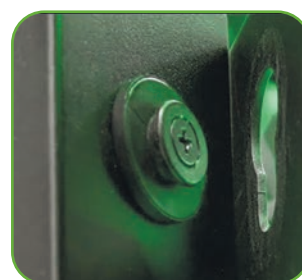
Крепление PDU без использования инструментов
