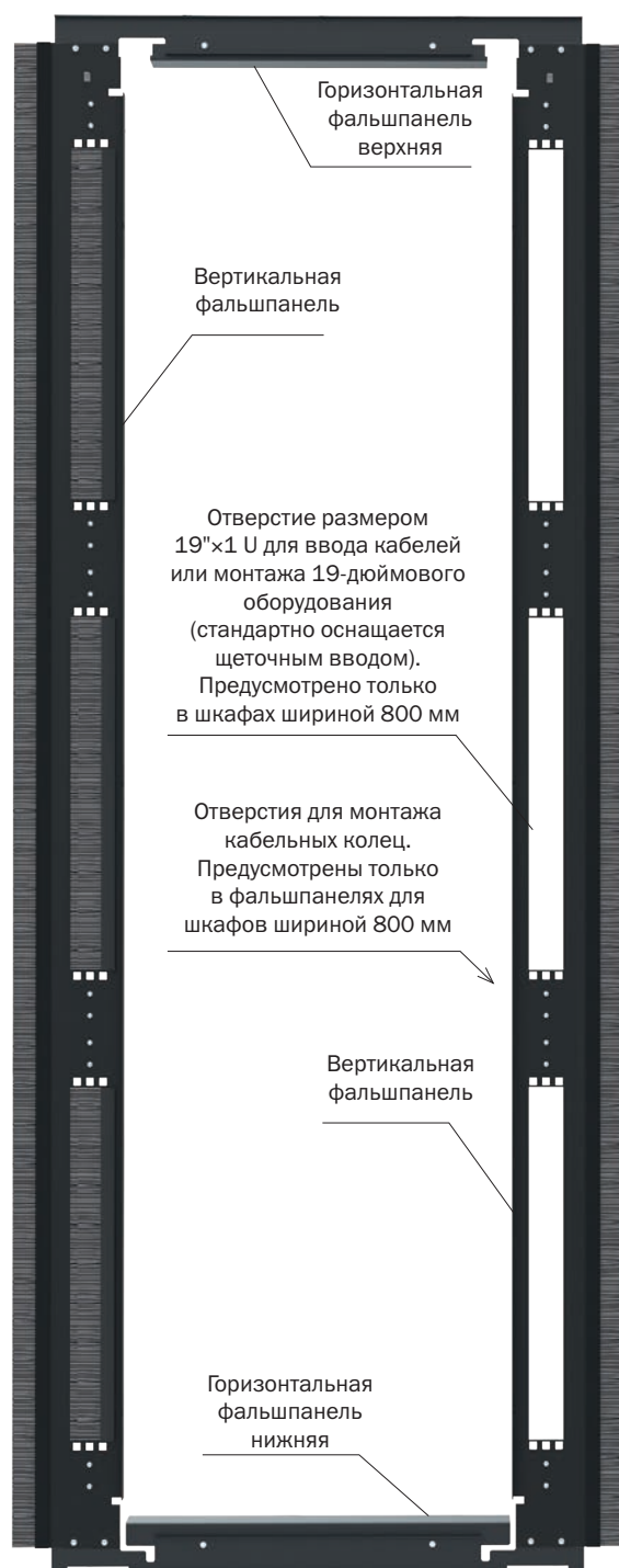
Горизонтальные и вертикальные фальшпанели для шкафа шириной 800 мм
